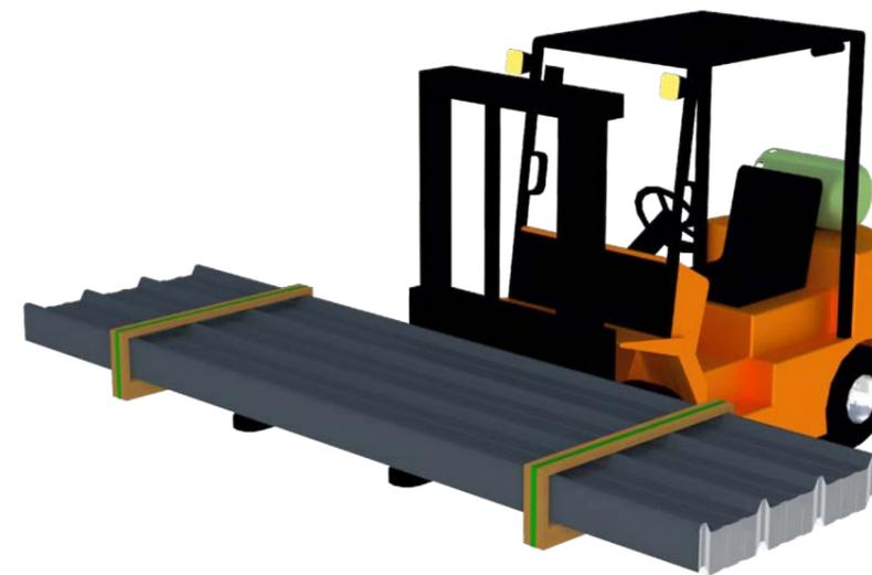
Attention : pour les colis de notre profil de couverture à joint debout (JI Vieo Edge) dont la longueur excède 3 m. Il est impératif que l'emplacement des fourches soit réglable et ajusté pour correspondre au tiers de la longueur du colis.
