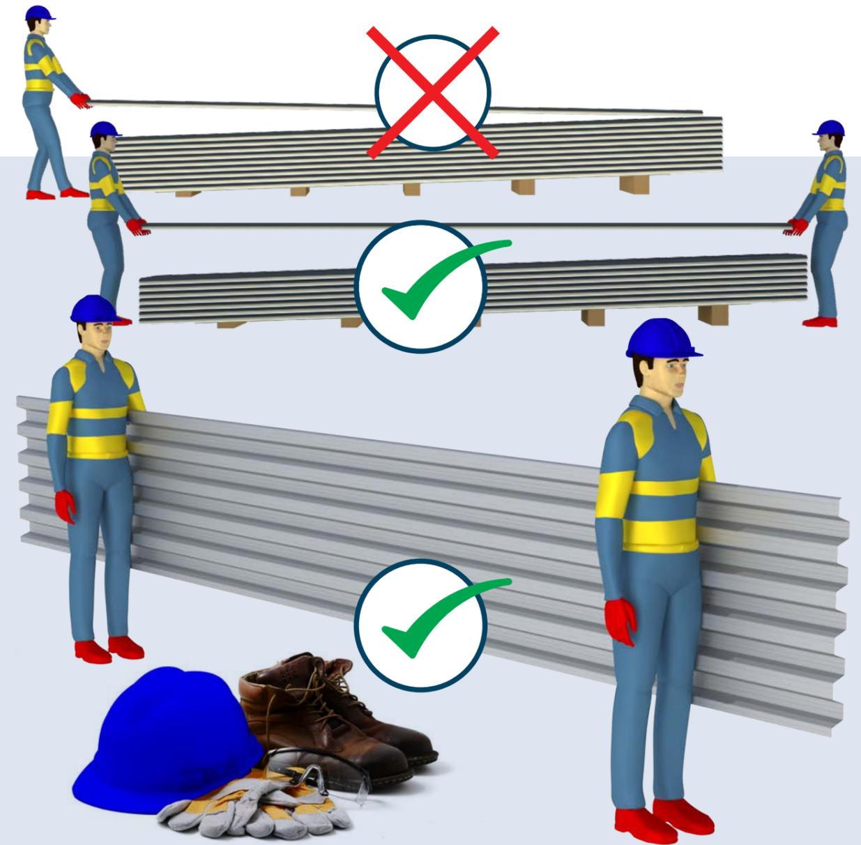
La manipulation des panneaux sandwich s'effectue en évitant leur prise par les rives, et de préférence sur chant avec le côté (emboîtement) mâle vers le bas. Le basculement sur chant de panneaux relativement long par rapport à leur épaisseur ( $L > 100 \times \text{épaisseur}$ ) est impératif pour éviter leur ruine.
